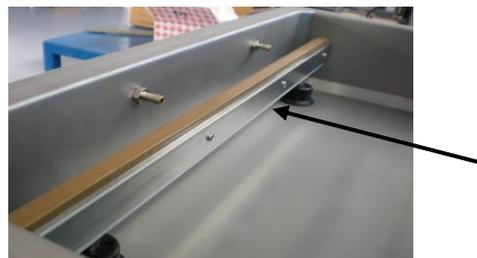
**Figura 8.1.** Barra de soldadura dentro de la cuba.
